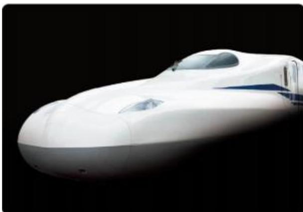
N700系以来のフルモデルチェンジ車両として2020年7月に営業開始する最新型の新幹線車両です。名前の「S」はN700系シリーズ中、「最高」を意味する「Supreme（スプリーム）」を表しています。左右両サイドにエッジを立てた「デュアルスプリームウイング形」と呼ばれる先頭形状を持ち、各種新技術によって安全性、安定性、快適性、環境性能を向上しつつ、省エネルギー化を図っています。（2020年7月現在）
