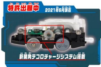
前進・後進両方向からの手転がしで、発電出来る機構を開発いたしました。(特許出願中)。前後に手転がしする動きで発電し、電動走行するという再生可能エネルギーの仕組みを実現し、お子さまが自分自身でエネルギーを生み出す喜びを得られます。
