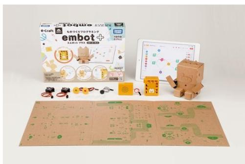
embot (エムボット) はダンボールと電子工作パーツを用いてロボットを組み立てることで、電子工作やものづくりの基礎を学ぶことができます。また、タブレット等にインストールした専用アプリを用いて、子どもでも簡単にプログラムを作り、組み立てたロボットを動かすことができます。それらの一連の作業を通してプログラミングを学ぶことができるサービスです。
