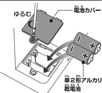
①電池カバーのネジをプラスドライバーでゆるめ、電池カバーを外します。
