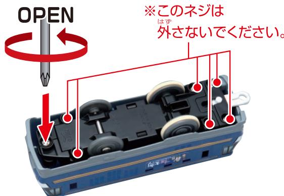
プラスドライバーでシャーシ先端のネジをゆるめ、
