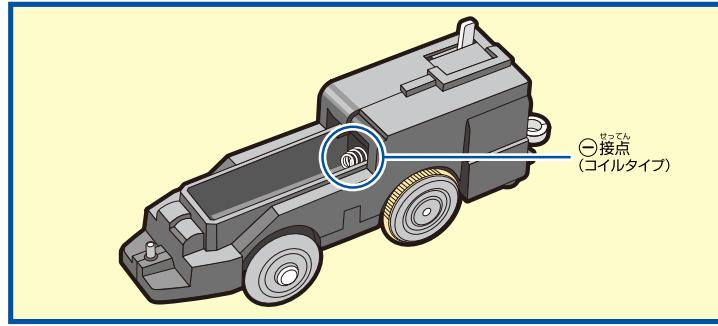
・電池をセットする際は、**イラスト①**のように、電池をなるべく本体(シャーシ)と平行になるような位置からセットしてください。**イラスト②**のように、電池を立てた状態からコイルをおおるようになると正しくセットしなかった場合、コイルが曲がり電池の外装ラベルが破損し、電池の発熱・破裂・液漏れの恐れがあります。
