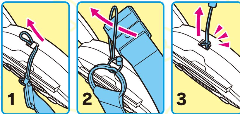
図のようにひもをストラップ穴に通してからストラップをくぐらせます。
