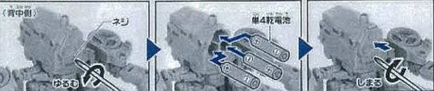
電池ボックスのフタのネジをプラスドライバで左に回し、フタを外してください。 単4乾電池3本を1を間違えないように、正しくセットしてください。 電池ボックスのフタを右に回し、ネジを右に回し、閉めてください。
