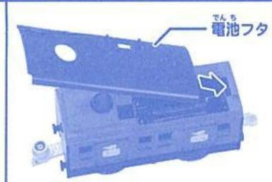
③電池フタのもどしかた **電池フタのフックを車体の穴**に 引っ掛けてもどした後にネジを しめてください。
