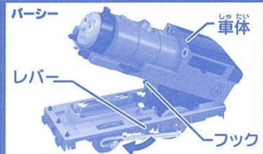
レバーを指で矢印の方向にスライドさせ ながら車体のフックをおし外し、車体を 写真のように取り外します。
