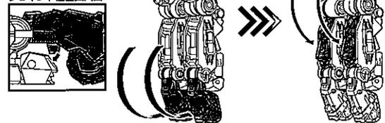
図のようにクローラー部を回転させ、クローラー部の凸がかかとの凹部に差し込みます。(左右)
