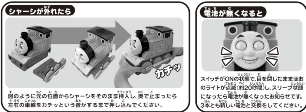
図のように元の位置からシャーシをそのまま挿入し、奥で止まったら左右の車輪をカチッという音がするまで押し込んでください。
