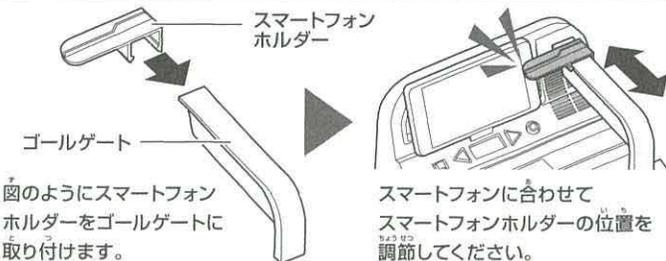
図のようにスマートフォンホルダーをゴールゲートに取り付けます。
