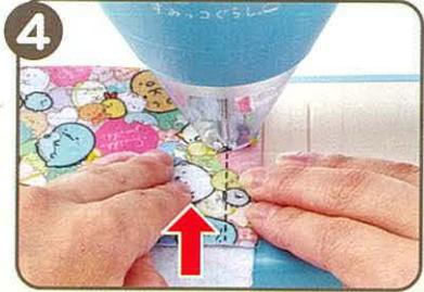
フェルトを透明カバーの下から、矢印の方向へ「ゆっくり」と送り、ステッチガイドに合わせてぬっていきます。透明カバー下側の凹みにぬい目ができていきます。
