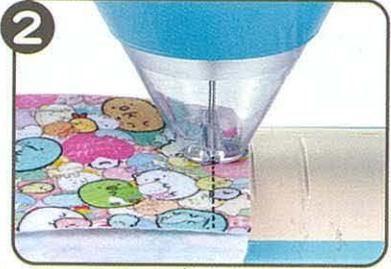
2枚のフェルトを重ねて本体のベッドの上(透明カバーの下)に置いてください。
