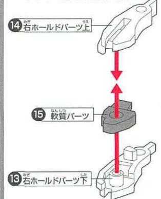
2 図のようにホルドパーツの穴に合わせてパーツをセットします。
