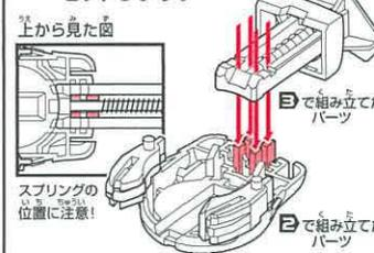
5 両側の穴と突起を合わせるようにパーツを組み立てます。
