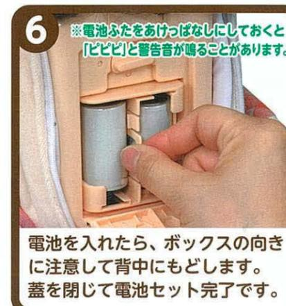
6 ※電池ふたをあげばなしにしておくと「ピピピ」と警告音が鳴ることがあります。電池を入れたら、ボックスの向きに注意して背中にもどします。蓋を閉じて電池セット完了です。
