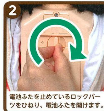
2 電池ふたを止めているロックパーツをひねり、電池ふたを開けます。
