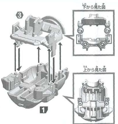
3 ②で組み立てたパーツと⑤を図の様に合わせてから、④をセットします。矢印①の方向に回して完成です。
