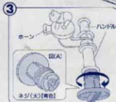
図(A)の六角形の凹みがあるネジ(大) [青色] を使って、ネジが付いているハンドルを締め、ハンドルとホーンの隙間をなくします。
