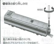
細めのプラスドライバーでゆるめて、 車体を取り外してください。
