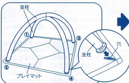
3 支柱が交差した部分に、面ファスナーで支柱留めを取り付けてください。
