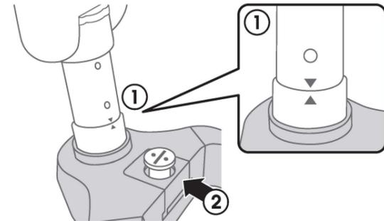
4 シートボックスの上下を確認し、図のように本体に差し込みます①。シートボックスを奥までしっかりと差し込んだことを確認したら、ハンドルロックユニットのネジにコインを差し込んで②、押し込みながら図の位置にロックします③。
