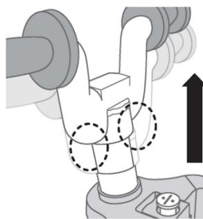
3 伸ばしたハンドル軸に彫刻された△印を合わせて①、ハンドルロックユニットを最後までしっかり戻します②。
