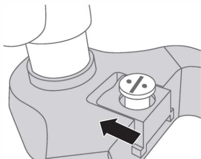
⑥ シートボックスの上下を確認し、図のように本体に差し込みます(①)。シートボックスを奥までしっかりと差し込んだことを確認したら、ハンドルロックユニットのネジにコインを差し込んで(②)、押し込みながら図の位置にロックします(③)。
