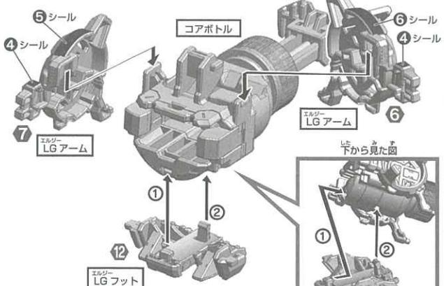
2 ①で組み立てたバーツと LG ヘッドを図の様にセットし、LG ショートバレルを⑨⑩⑪の順に組み上げてから①、②の順にセットして完成です。
