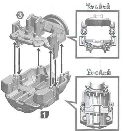
3 ②で組み立てたバーツと⑤を図の様に合わせてから、④をセットします。矢印Aの方向に回して完成です。
