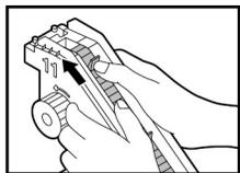
外れたベルトを図のように押さえながら両手の親指で矢印の方向に送り込んでください。
