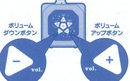
ボリューム・アップ/ダウンボタンを押すと、ミュート(消音)含めて16段階の調節ができます。
