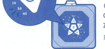
タイマー切り替えボタンを押すと約15分、30分、45分の順に点灯し、設定時間が変わります(45分の時は15分に戻ります)。設定時間になると自動的に電源がOFFになります(再生途中でOFFになることもあります)。
