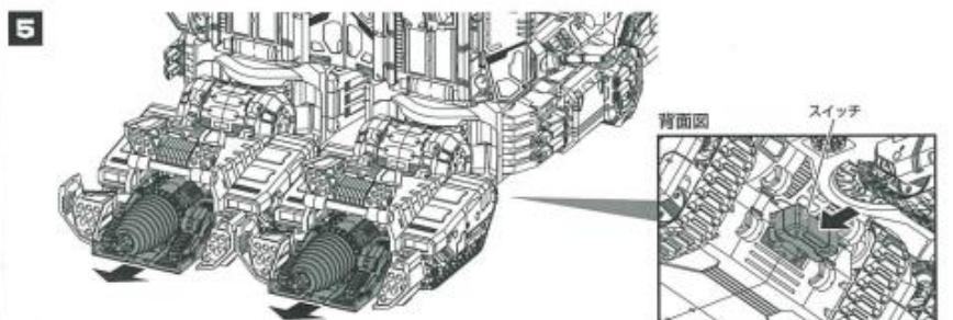
背面にあるスイッチを押し、格納トレイを引き出します。
