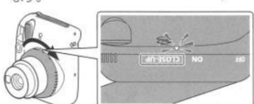
クローズアップモードを使用すると、よりキレイにセルフイーで撮影することができます。レンズ前面のセルフイーミラーで、構図を確認しながら撮影することができます。
