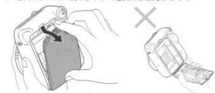
2 フィルムパックの左右を持ち、フィルムパックにある黄色の線とカメラ内部の黄色のマークを合わせ、まっすぐ押し込むようにフィルムパックを入れます。
