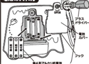
①本体側面(はちみつ遊びの面)の電池カバーのネジをプラスドライバーで矢印の方向にゆるめ、電池カバーをはずします。
