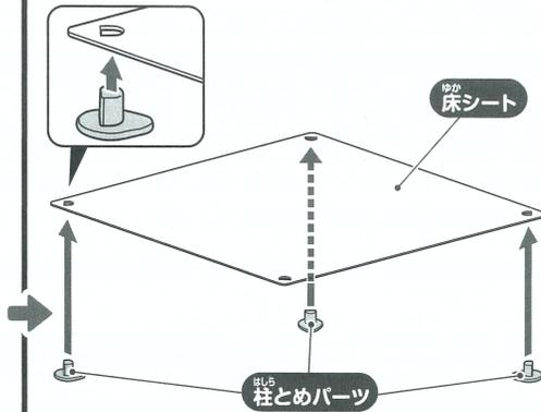
平らなところに好きな向きで床シートを置き、床シートの角にある3箇所の穴に、柱とめパーツを穴の形にあわせて図のように差し込んでください。
