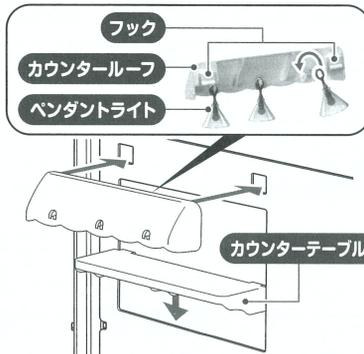
カウンターは壁の上の2つの穴に、カウンターテーブルは下の大きな穴に裏面にあるフックを引っ掛けて取り付けてください。
