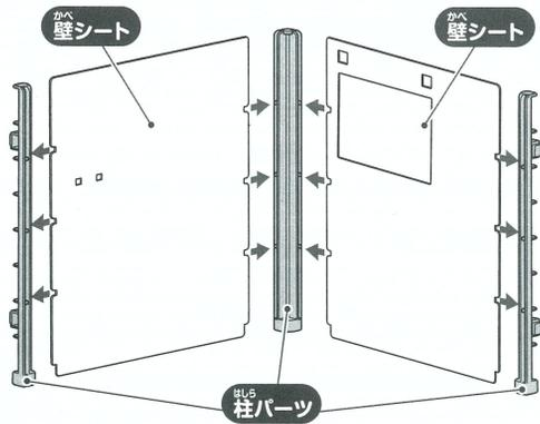
図のように柱パーツの溝に壁シートを差し込んでください。壁シートは左右入れ替え可能です。
