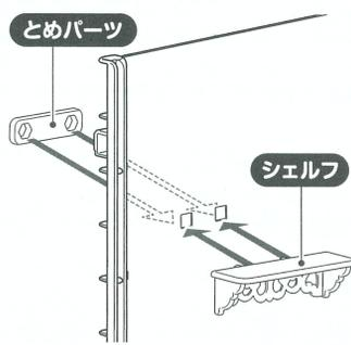
シェルフの裏面にある凸を図のように壁シートの穴に差し込み、裏からとめパーツでとめます。
