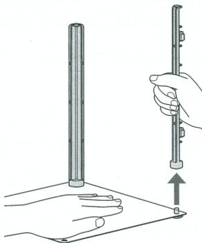
壁シートを取り外したあとに床シートをしっかりとおさえ、柱パーツを1箇所ずつ上に引き抜いて取り外してください。
