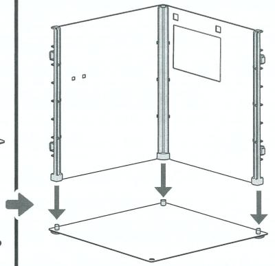
図のように柱とめパーツに柱パーツを上から差し込んでルームの完成です。壁と床は表裏でデザインが違うので、いろいろな組み合わせができます。
