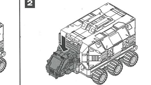
図のジョイントにボレットモジュール（コムヘッド）を取り付けます。
