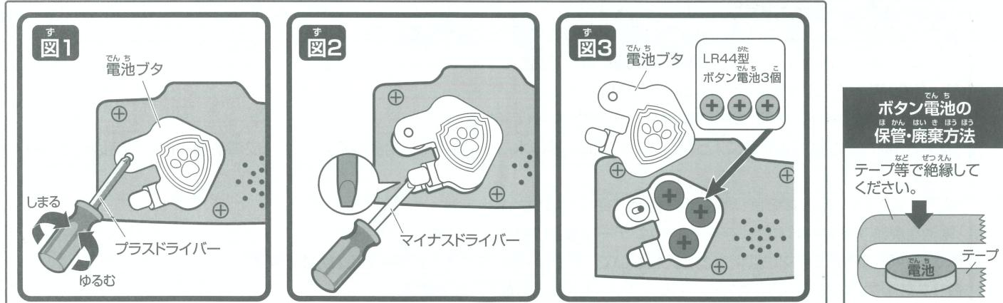
①プラスドライバーで電池ブタのネジをゆるめます。
