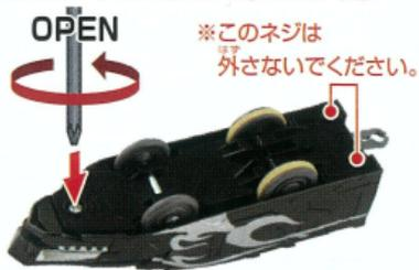
プラスドライバーでシャーシ先端のネジをゆるめ、ボディを取り外してください。
