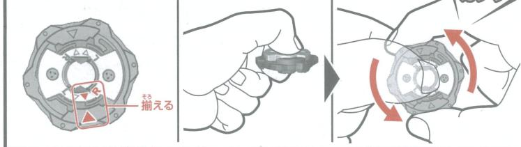
③ブレードとラケットを重ねます。ブレードの裏にあるラケットカバーと同じ形の凹みに、ラケットカバーを合わせるようにしてください。
