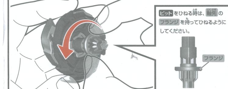
③ひねったビットを押し込むとロックチップが外れ、3パートに分解できます。
