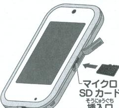
本体右側面のカバーを外し、マイクロSDカードを挿入口に図のような向きでカチッというまで押し込んで装着してください。再度マイクロSDカードをカチッと音がするまで押し込むと取り外すことができます。その際、マイクロSDカードが飛び出さないよう、指の腹で押さえながら取り出してください。挿入する向きに注意してください。
