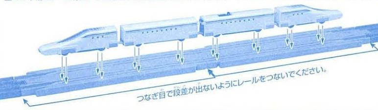
車輪がはまるレールだけが溝になっているので、車両が載せやすく、スムーズなセットが可能です。
