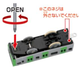
プラスドライバーでシャーシ先端のネジをゆるめ、ボディを取り外してください。
