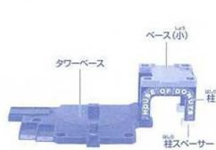
タワーベースに柱スペーサーを取り付けた柱を2つ組み、その上にベース(小)を組みます。
