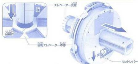
回転エレベーター本体の穴の凸部分とエレベーター支柱の溝をあわせ、本体の裏側にあるセットレバーを矢印の方向に押しなが、エレベーター支柱を本体の半分位の位置まで差し込みます。
