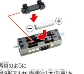
写真のように単3形アルカリ乾電池1本(別売)を⊕⊖を間違えないように正しくセットして、電池フタを戻し、ネジをしめてください。
