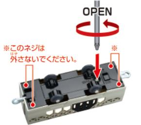
プラスドライバーでネジをゆるめ、電池フタを取り外してください。
