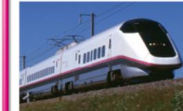
E3系新幹線は、1997年に開業した秋田新幹線用車両として開発されました。盛岡駅から先の在来線区間に応える「新在直通運転」の第2号として、一般的な新幹線車両より小型に作られています。
