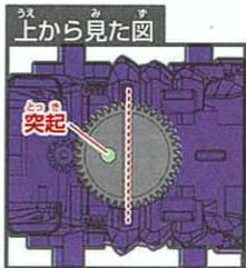
ギアの突起が図の位置にくるように取り付けよう。
